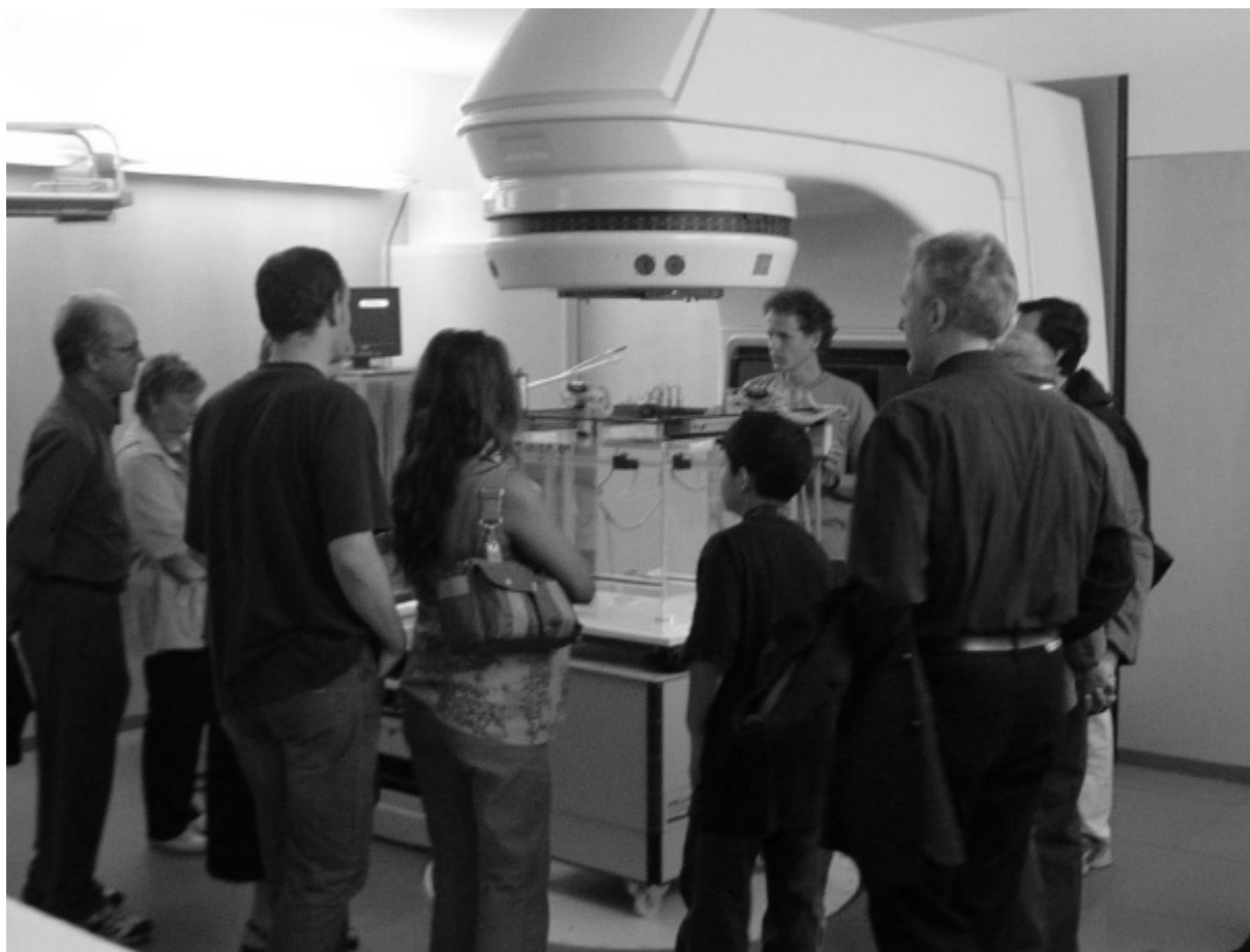
Lindenhospital in Bern: Vorführung des Wasserphantoms zur Strahl Datenaufnahme durch den Medizinphysiker
