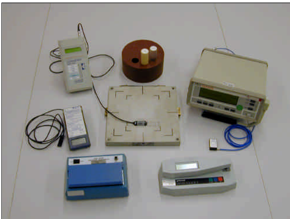
Abbildung 2: Prüfkörper und Messgeräte für die Konstanzprüfungen an konventionellen Röntgengeräten, Durchleuchtungs-, Mammographie- und CT-Geräten sowie an Entwicklungsmaschinen.
